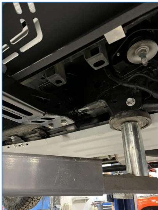
Зачистите сварочные швы и прилегающие поверхности.
