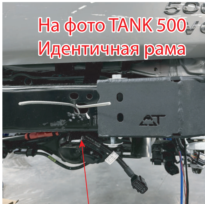
Установка закладных гаек №36 через указанное отверстие рамы
