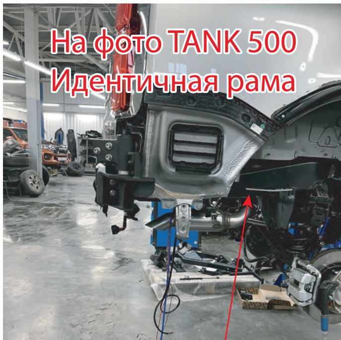
Установка закладной гайки №38 через боковое отверстие рамы
