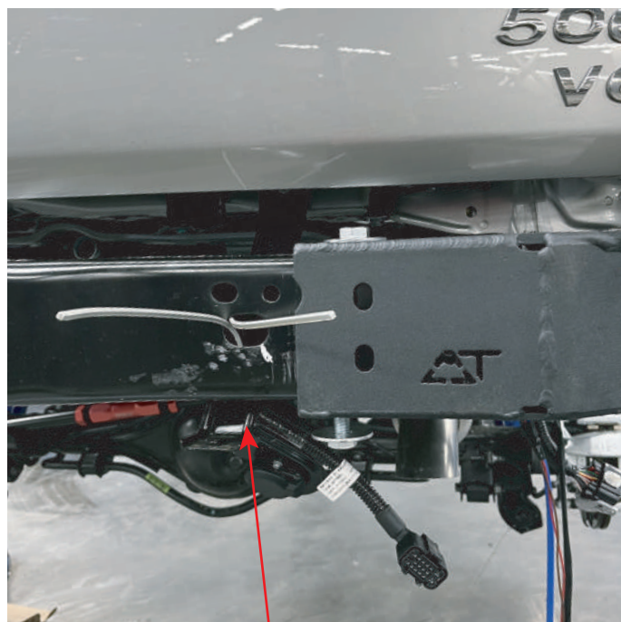
Установка закладных гаек №36 через указанное отверстие рамы
